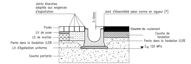
Montage suivant catalogue des structures types de chaussées avec des couches de fondation anti-gel (composition libre)
