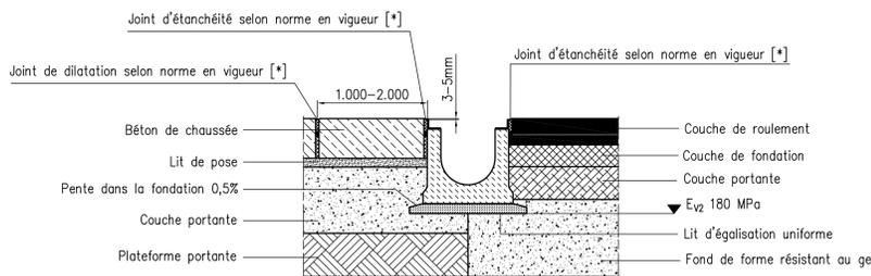
Montage suivant catalogue des structures types de chaussées avec des couches de fondation anti-gel (composition libre)
